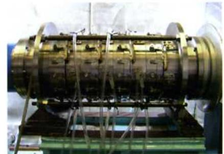
図4 過渡現象研究用三段軸流圧縮機
