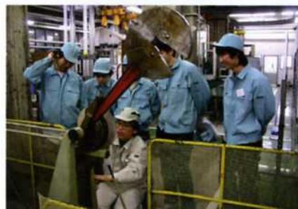
鉄鋼材料の衝撃試験
