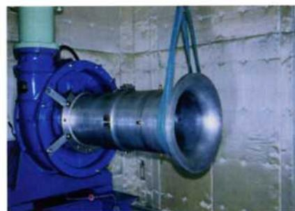
図2 過給機用遠心圧縮機
