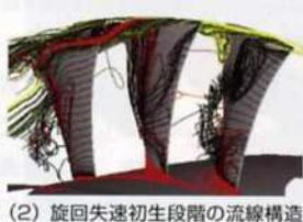
(2) 旋回失速初生段階の流線構造(非定常3次元RANS)
