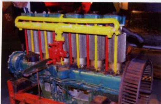
図2 空冷6気筒エンジン
