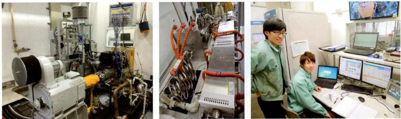
図1 写真左から、世界各国の走行モードが可能なエンジンベンチ、模擬排ガス、実機排ガスが導入可能な触媒リアクター、エンジンオペレータールーム
