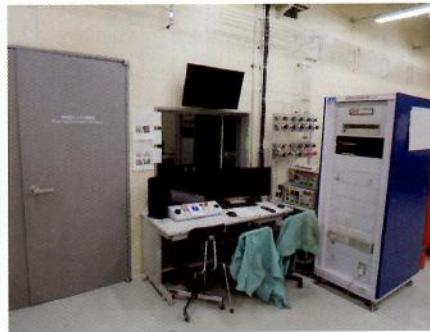
図2 写真左から、噴霧燃焼（手前）、火炎伝播（奥）観察容器、単気筒ディーゼルエンジン操作室（中央）、ハイブリッド燃焼実験用エンジン（右）
