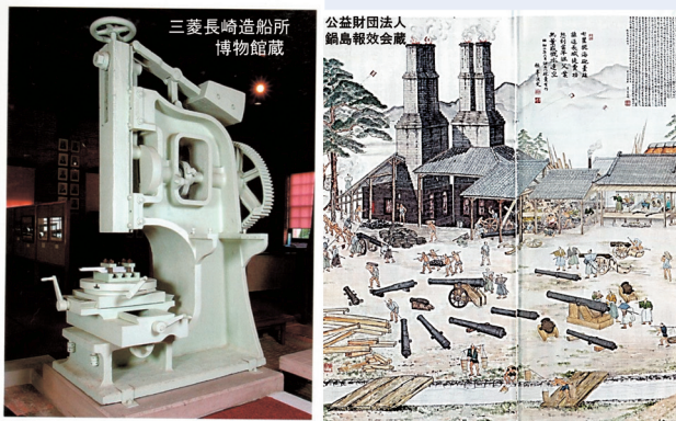
図3 最古の工作機械(左)と大砲鑄造の反射炉(右)
