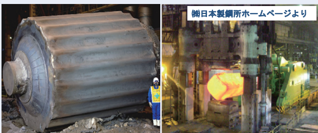
図2 600トンインゴットとロータシャフトの熱間鍛造
