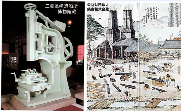
図3 最古の工作機械(左)と大砲鑄造の反射炉(右)
