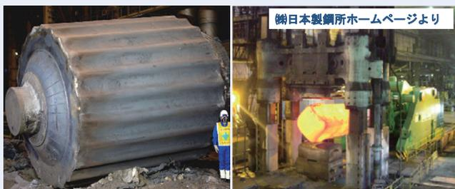
図2 600トンインゴットとロータシャフトの熱間鍛造
