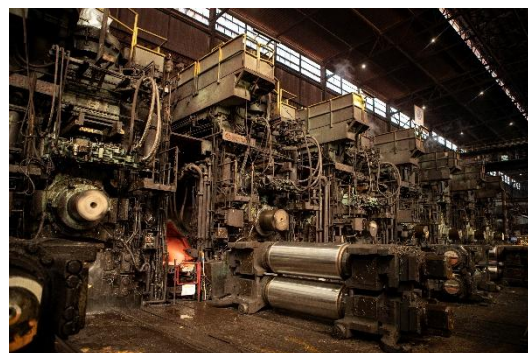
筆者が務める工場の熱間圧延システム
